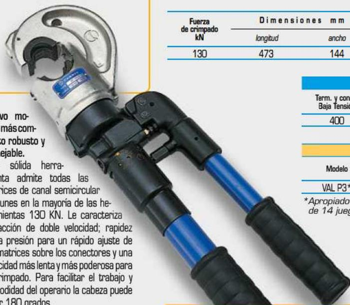
Nuevo modelo más compacto robusto y manejable. Esta sólida herramienta admite todas las matrices de canal semicircular comunes en la mayoría de las herramientas 130 KN. Le caracteriza su acción de doble velocidad; rapidez en la presión para un rápido ajuste de las matrices sobre los conectores y una velocidad más lenta y más poderosa para el crimpado. Para facilitar el trabajo y comodidad del operario la cabeza puede rotar 180 grados.
