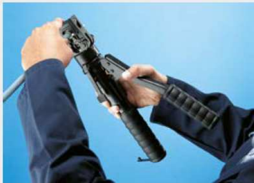
El operario puede ajustar las matrices utilizando una sola mano dejando la otra libre para introducir el conector.
